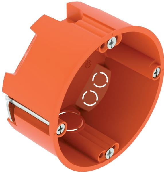
Hohlwand-Gerätedose für den Einsatz in Hohlwänden mit einer Einbautiefe von mindestens 35 mm und einer Plattenstärke von 5 - 28 mm.
