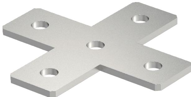
Verbindungsplatte mit 5 Löchern zur Kreuzverbindung von Profilschienen 41 x 41 mm und 41 x 21 mm.
