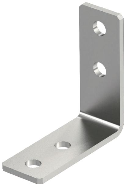
Montagewinkel mit 2 Löchern zur Verbindung von Profilschienen 41 x 41 mm und 41 x 21 mm im Winkel von 90°.
