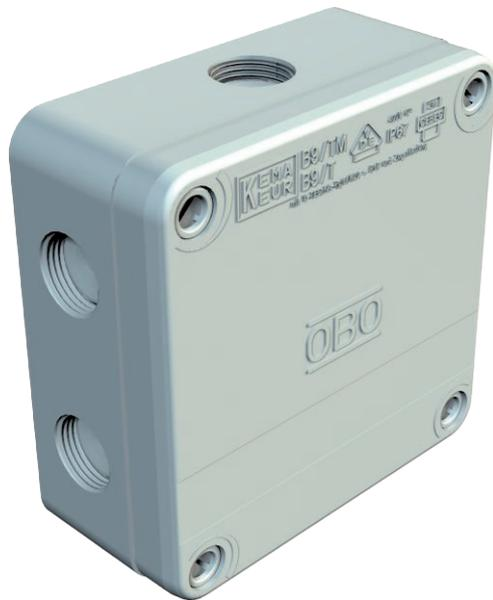
B9/T... besteht aus zwei verschiedenen halogenfreien Kunststoffkomponenten, 8 Gewindeeinführungen (PG16) mit Durchstoßmembran (für Kabeldurchmesser bis 15 mm) im Bodenbereich. Bei Verwendung der Kabelverschraubungen (zusätzliche Zugentlastung) ist ein Entfernen der Membran nicht erforderlich (Zeitgewinn). Schutzart IP 67 bei Durchstoßmembrane und bei Kabelverschraubung ohne Entfernen der Durchstoßmembrane.
