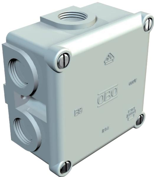
Schutzart IP54, Nennspannung 660 V, Nennquerschnitt 2,5 mm<sup>2</sup>, 2 Befestigungslöcher für Schrauben bis 5 mm Ø an der Außenseite des Kastens, 4 Deckelschrauben, 7 ausbrechbare Einführungen mit Gewinde M20 x 1,5, vorzugsweise für Kabelverschraubungen mit kurzem Anschlussgewinde.
