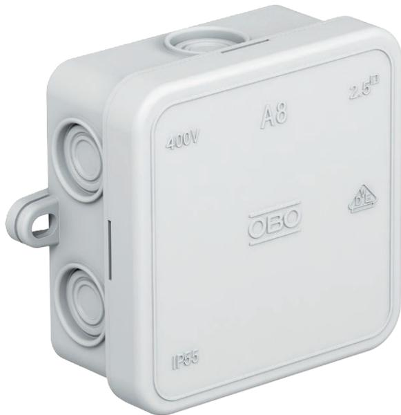
Schutzart IP55, Nennspannung 400 V, Nennquerschnitt 2,5 ÷ mm<sup>2</sup>, 7 Einführungen für Kabeldurchmesser 5-14 mm.
