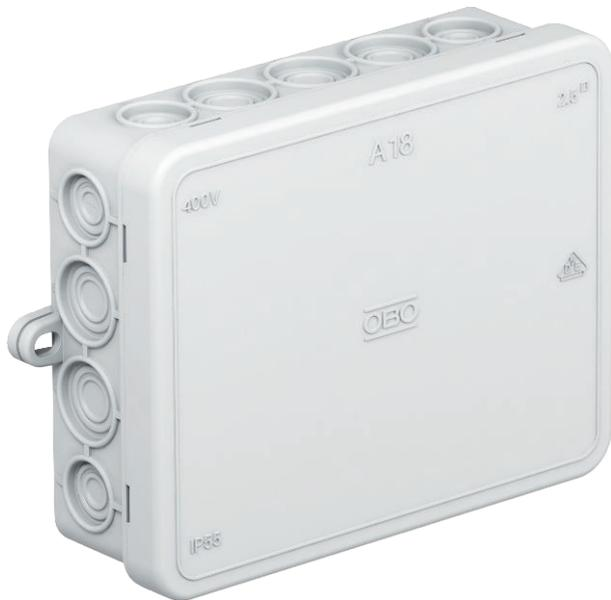
Schutzart IP55, Nennspannung 400 V, Nennquerschnitt 2,5 ÷ mm<sup>2</sup>, 10 Einführungen für Kabeldurchmesser 5-14 mm
