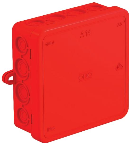
Schutzart IP55, Nennspannung 400 V, Nennquerschnitt 2,5 ÷ mm<sup>2</sup>, 8 Einführungen für Kabeldurchmesser 5-14 mm
