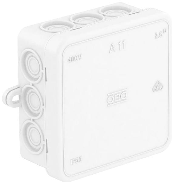
Schutzart IP55, Nennspannung 400 V, Nennquerschnitt 2,5 ÷ mm<sup>2</sup>, 12 Einführungen für Kabeldurchmesser 5-14 mm.
