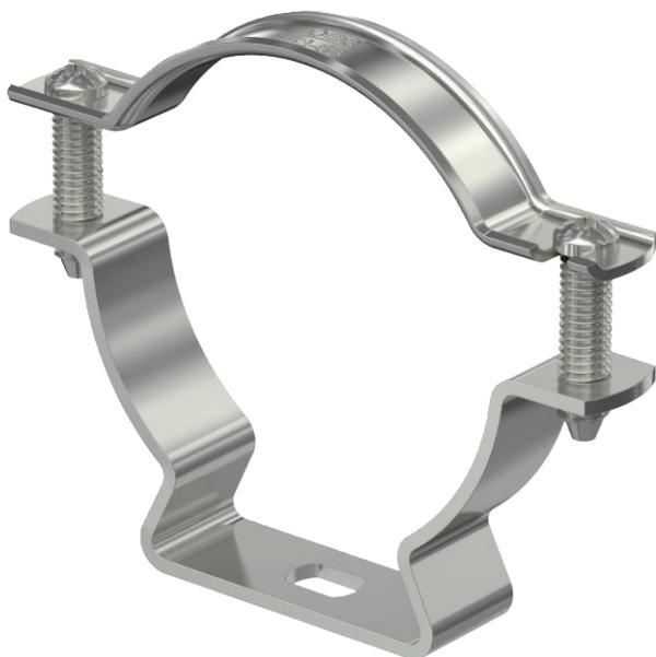
Abstandschele zur Montage von Röhren und Kabeln an Wand, Decke und Boden. Mit selbstsicherndem Oberteil. Befestigung über Langloch. Zugelassen für den Funktionserhalt nach DIN 4102 Teil 12, Funktionserhaltklassen E 30 bis E 90.
