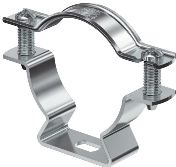
Abstandschele zur Montage von Röhren und Kabeln an Wand, Decke und Boden. Mit selbstsicherndem Oberteil. Befestigung über Langloch. Ab der Schellengröße 20 geeignet für Montage mit Nagelgerät oder Bolzensetzgerät. Zugelassen für den Funktionserhalt nach DIN 4102 Teil 12, Funktionserhaltklassen E 30 bis E 90 (außer ALU).
