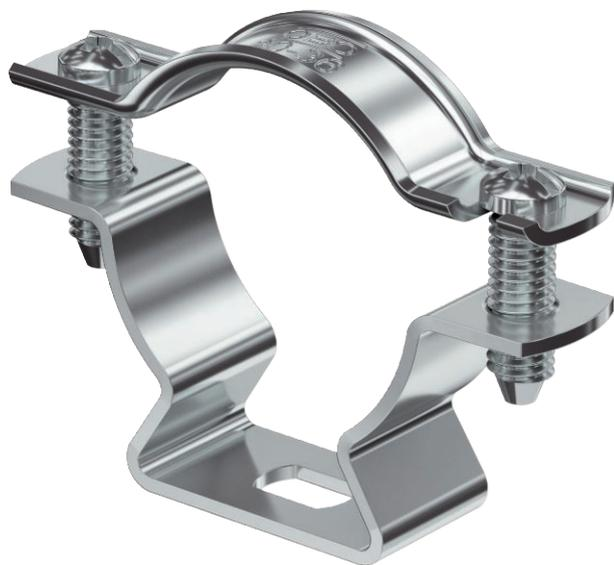
Abstandschele zur Montage von Röhren und Kabeln an Wand, Decke und Boden. Mit selbstsicherndem Oberteil. Befestigung über Langloch. Ab der Schellengröße 20 geeignet für Montage mit Nagelgerät oder Bolzensetzgerät. Zugelassen für den Funktionserhalt nach DIN 4102 Teil 12, Funktionserhaltklassen E 30 bis E 90 (außer ALU).
