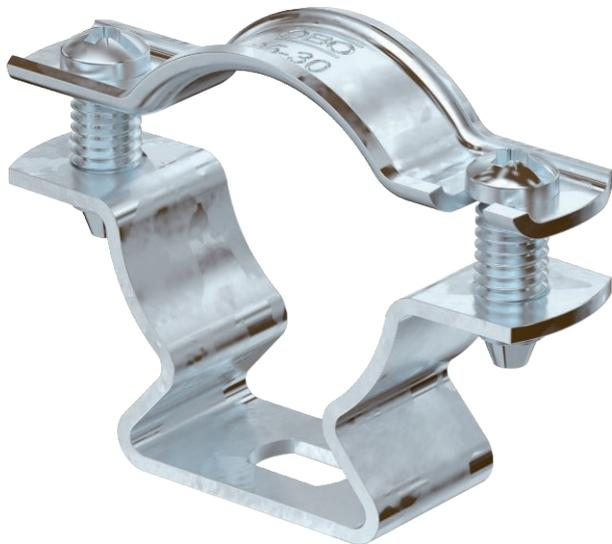
Abstandschelle zur Montage von Röhren und Kabeln an Wand, Decke und Boden. Mit selbstsicherndem Oberteil. Befestigung über Langloch. Zugelassen für den Funktionserhalt nach DIN 4102 Teil 12, Funktionserhaltklassen E 30 bis E 90.
