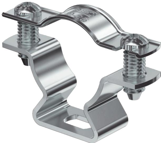
Abstandschelle zur Montage von Röhren und Kabeln an Wand, Decke und Boden. Mit selbstsicherndem Oberteil. Befestigung über Langloch. Ab der Schellengröße 20 geeignet für Montage mit Nagelgerät oder Bolzensetzgerät. Zugelassen für den Funktionserhalt nach DIN 4102 Teil 12, Funktionserhaltklassen E 30 bis E 90 (außer ALU).
