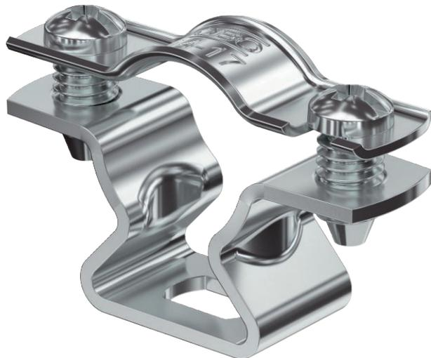
Abstandschelle zur Montage von Röhren und Kabeln an Wand, Decke und Boden. Mit selbstsicherndem Oberteil. Befestigung über Langloch. Ab der Schellengröße 20 geeignet für Montage mit Nagelgerät oder Bolzensetzgerät. Zugelassen für den Funktionserhalt nach DIN 4102 Teil 12, Funktionserhaltklassen E 30 bis E 90 (außer ALU).
