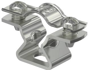
Abstandschelle zur Montage von Rohren und Kabeln an Wand, Decke und Boden. Mit selbstsicherndem Oberteil. Befestigung über Langloch. Zugelassen für den Funktionserhalt nach DIN 4102 Teil 12, Funktionserhaltklassen E 30 bis E 90.
