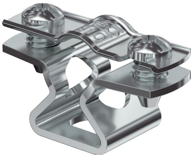
Abstandschele zur Montage von Röhren und Kabeln an Wand, Decke und Boden. Mit selbstsicherndem Oberteil. Befestigung über Langloch. Ab der Schellengröße 20 geeignet für Montage mit Nagelgerät oder Bolzensetzgerät. Zugelassen für den Funktionserhalt nach DIN 4102 Teil 12, Funktionserhaltklassen E 30 bis E 90 (außer ALU).
