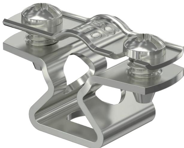
Abstandschelle zur Montage von Röhren und Kabeln an Wand, Decke und Boden. Mit selbstsicherndem Oberteil. Befestigung über Langloch. Zugelassen für den Funktionserhalt nach DIN 4102 Teil 12, Funktionserhaltklassen E 30 bis E 90.
