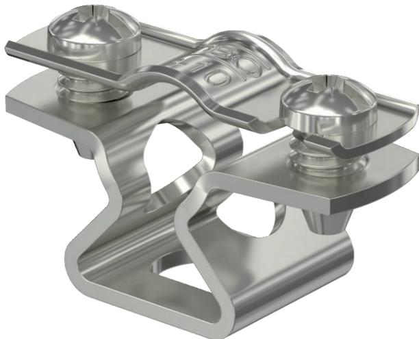
Abstandschele zur Montage von Röhren und Kabeln an Wand, Decke und Boden. Mit selbstsicherndem Oberteil. Befestigung über Langloch. Zugelassen für den Funktionserhalt nach DIN 4102 Teil 12, Funktionserhaltklassen E 30 bis E 90.
