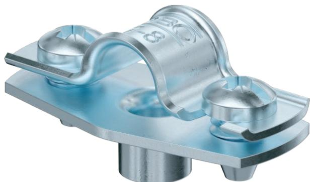
Abstandschele zur Montage von Rohren und Kabeln an Wand, Decke und Boden. Mit selbstsicherndem Oberteil. Befestigung über Ansatz mit Innengewinde. Zugelassen für den Funktionserhalt nach DIN 4102 Teil 12, Funktionserhaltklassen E 30 bis E 90.
