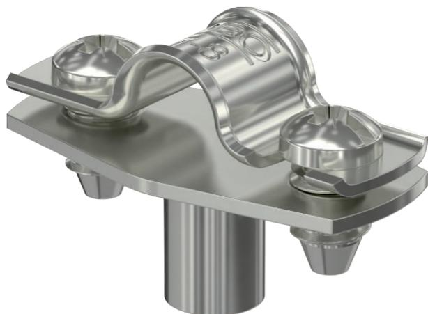
Abstandschele zur Montage von Röhren und Kabeln an Wand, Decke und Boden. Mit selbstsicherndem Oberteil. Befestigung über Ansatz mit Innengewinde. Oberflächen G und FT ab Schellengröße 20 geeignet für Montage mit Nagelgerät oder Bolzensetzgerät. Zugelassen für den Funktionserhalt nach DIN 4102 Teil 12, Funktionserhaltklassen E 30 bis E 90.
