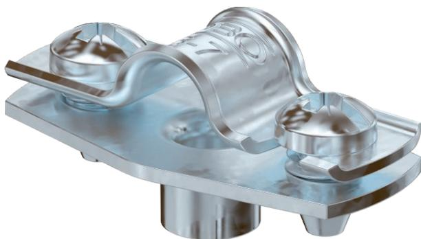
Abstandschele zur Montage von Röhren und Kabeln an Wand, Decke und Boden. Mit selbstsicherndem Oberteil. Befestigung über Ansatz mit Innengewinde. Oberflächen G und FT ab Schellengröße 20 geeignet für Montage mit Nagelgerät oder Bolzensetzgerät. Zugelassen für den Funktionserhalt nach DIN 4102 Teil 12, Funktionserhaltklassen E 30 bis E 90.
