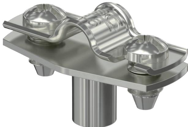
Abstandschele zur Montage von Rohren und Kabeln an Wand, Decke und Boden. Mit selbstsicherndem Oberteil. Befestigung über Ansatz mit Innengewinde. Oberflächen G und FT ab Schellengröße 20 geeignet für Montage mit Nagelgerät oder Bolzensetzgerät. Zugelassen für den Funktionserhalt nach DIN 4102 Teil 12, Funktionserhaltklassen E 30 bis E 90.
