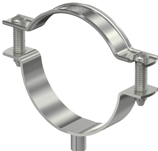
Abstandschelle zur Montage von Röhren und Kabeln an Wand, Decke und Boden. Mit selbstsicherndem Oberteil. Befestigung über Ansatz mit Innengewinde. Oberflächen G und FT ab Schellengröße 20 geeignet für Montage mit Nagelgerät oder Bolzensetzgerät. Zugelassen für den Funktionserhalt nach DIN 4102 Teil 12, Funktionserhaltklassen E 30 bis E 90.
