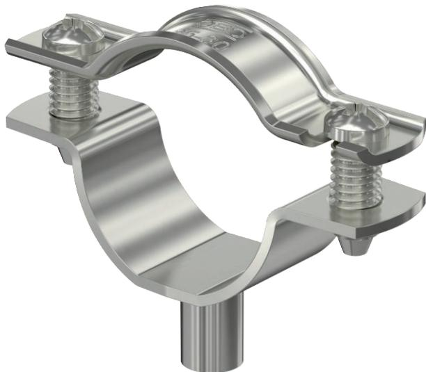
Abstandschele zur Montage von Röhren und Kabeln an Wand, Decke und Boden. Mit selbstsicherndem Oberteil. Befestigung über Ansatz mit Innengewinde. Oberflächen G und FT ab Schellengröße 20 geeignet für Montage mit Nagelgerät oder Bolzensetzgerät. Zugelassen für den Funktionserhalt nach DIN 4102 Teil 12, Funktionserhaltklassen E 30 bis E 90.
