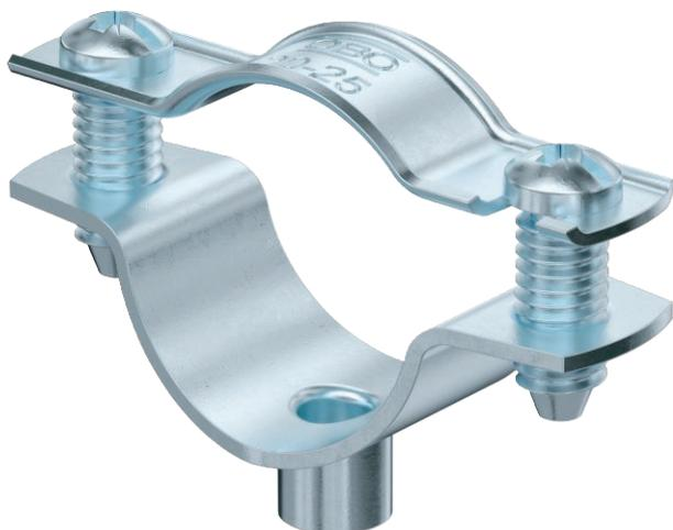
Abstandschelle zur Montage von Rohren und Kabeln an Wand, Decke und Boden. Mit selbstsicherndem Oberteil. Befestigung über Ansatz mit Innengewinde. Zugelassen für den Funktionserhalt nach DIN 4102 Teil 12, Funktionserhaltklassen E 30 bis E 90.
