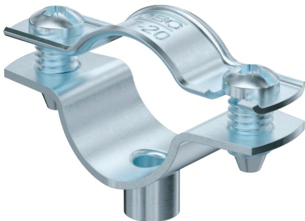
Abstandschele zur Montage von Rohren und Kabeln an Wand, Decke und Boden. Mit selbstsicherndem Oberteil. Befestigung über Ansatz mit Innengewinde. Zugelassen für den Funktionserhalt nach DIN 4102 Teil 12, Funktionserhaltklassen E 30 bis E 90.
