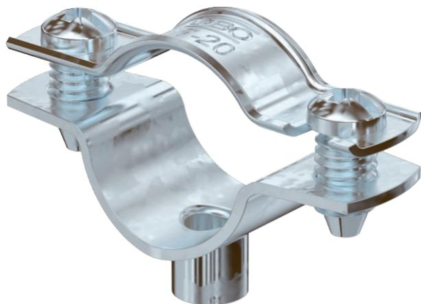
Abstandschele zur Montage von Rohren und Kabeln an Wand, Decke und Boden. Mit selbstsicherndem Oberteil. Befestigung über Ansatz mit Innengewinde. Oberflächen G und FT ab Schellengröße 20 geeignet für Montage mit Nagelgerät oder Bolzensetzgerät. Zugelassen für den Funktionserhalt nach DIN 4102 Teil 12, Funktionserhaltklassen E 30 bis E 90.
