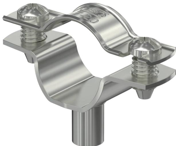
Abstandschele zur Montage von Röhren und Kabeln an Wand, Decke und Boden. Mit selbstsicherndem Oberteil. Befestigung über Ansatz mit Innengewinde. Oberflächen G und FT ab Schellengröße 20 geeignet für Montage mit Nagelgerät oder Bolzensetzgerät. Zugelassen für den Funktionserhalt nach DIN 4102 Teil 12, Funktionserhaltklassen E 30 bis E 90.
