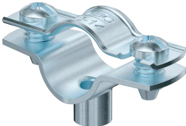
Abstandschelle zur Montage von Röhren und Kabeln an Wand, Decke und Boden. Mit selbstsicherndem Oberteil. Befestigung über Ansatz mit Innengewinde. Zugelassen für den Funktionserhalt nach DIN 4102 Teil 12, Funktionserhaltklassen E 30 bis E 90.
