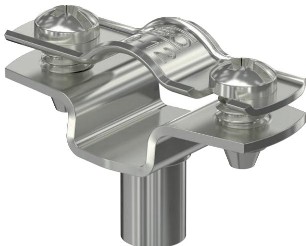
Abstandschelle zur Montage von Röhren und Kabeln an Wand, Decke und Boden. Mit selbstsicherndem Oberteil. Befestigung über Ansatz mit Innengewinde. Oberflächen G und FT ab Schellengröße 20 geeignet für Montage mit Nagelgerät oder Bolzensetzgerät. Zugelassen für den Funktionserhalt nach DIN 4102 Teil 12, Funktionserhaltklassen E 30 bis E 90.
