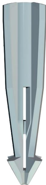
Der Dübel kann direkt in den Porenbeton (Gasbetonfestigkeitsklasse G2) eingeschlagen werden. Ab der Festigkeitsklasse G4 sollte ein 5 mm bzw. 6 mm Loch vorgebohrt werden.
