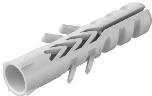
Erforderliche Mindestschraubenlänge = Dübellänge + Bauteildicke + 1 x Schrauben-Ø. Auszugskraft gilt für Holzschrauben mit dem jeweils größtem Schraubendurchmesser, erforderliche Sicherheitsbeiwerte sind zu berücksichtigen.
