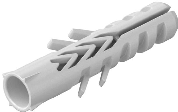
Erforderliche Mindestschraubenlänge = Dübellänge + Bauteildicke + 1 x Schrauben-Ø.
