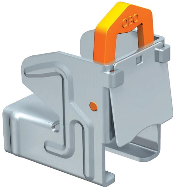
Rostschutzbeschichtete Trägerklammer schraubenlos, mit Sperrfeder passend für Profilschienen Typ CML3518 und CMS3518. Zur schnellen Befestigung an Stahlprofilen bei der Montage von Kabelbahnen, Bügelschellen, Leuchtaufhängungen usw. Ein komplettes System besteht aus 2 Trägerklammern und einem Stück C-Profilschiene beliebiger Länge, sowie 2 Schutzkappen.
