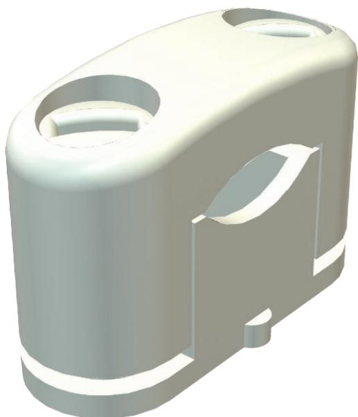
Mit Kunststoffschrauben, daher korrosionssicher, mit Langloch zur Befestigung mittels Holzschrauben oder Schlagdübel 5 mm.
