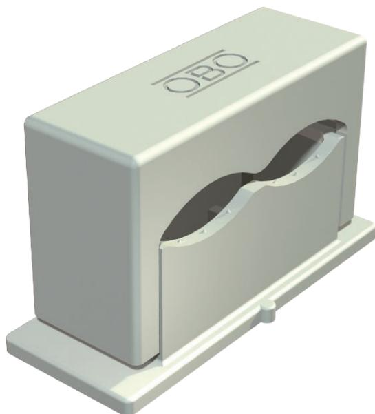
Für 2 Leitungen, mit Klebefuß, Langloch und zum Aufschrauben auf Gewinde M6.
