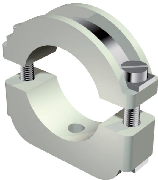
Blitz-Iso-Schellen: Kunststoffschelle mit Metalleinlage, daher auch für schwere Beanspruchung geeignet; Metallteile aus Stahl, galvanisch verzinkt. Aufschraubbar auf Gewinde M6.
