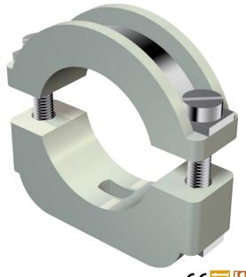
Blitz-Iso-Schellen: Kunststoffschelle mit Metalleinlage, daher auch für schwere Beanspruchung geeignet; Metallteile aus Stahl, galvanisch verzinkt. 3015 mit Langloch 4,5 mm.
