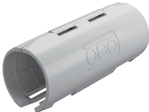
Verbindungsmuffe für Elektroinstallationsrohre aus Kunststoff zum Erstellen von Längsverbindungen. Geeignet für Rohr Quick-Pipe oder Wellrohre. Werkzeugloses Verschließen und Öffnen. Einsetzbar im Temperaturbereich von -25° bis +60° C.
