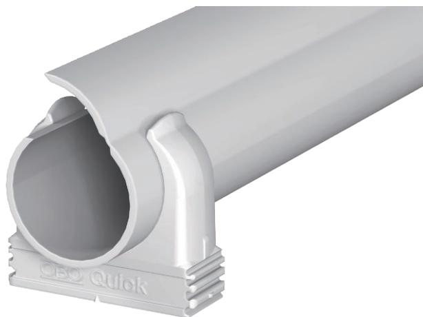
Set aus Elektroinstallationsrohren Quick-Pipe und Aufputzschellen Quick-Schelle. Zum Aufputz-Verlegen von Kabel und Leitungen im Innen- und geschützten Außenbereich. Universelle Befestigung an Wand und Decke. Umfasst 50 m Rohr zu je 2 Meter Länge und 156 Quick-Schellen. Einsetzbar im Temperaturbereich von -25° bis +60° C.
