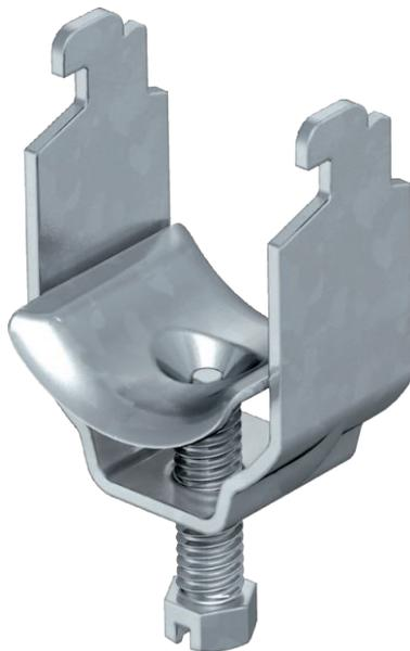
Passend zu allen C-Profilshienen mit 11 - 12 mm Schlitzweite; mindestens 6,5 mm lichter Innenhöhe und mindestens 18,5 mm lichter Innenbreite;
