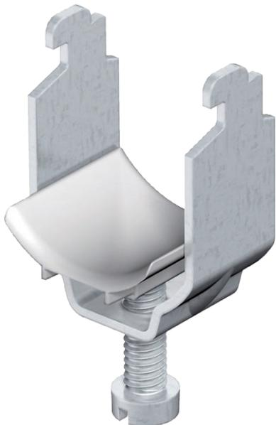
Passend zu allen Profilschienen mit 11 - 12 mm Schlitzweite, mindestens 6,5 mm lichter Innenhöhe und mindestens 18,5 mm lichter Innenbreite;
