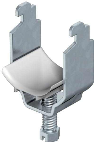
Passend zu allen C-Profileschienen mit 11 - 12 mm Schlitzweite, mindestens 6,5 mm lichter Innenhöhe und mindestens 18,5 mm lichter Innenbreite.
