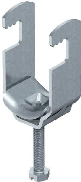
Bügelzelle zur Befestigung von Kabeln und Röhren. Geeignet für Flach-, Winkel- und U-Eisen von 4 - 12 mm Stärke. Metallwanne mit stark gerundeten Kanten zum Kabelschutz.
