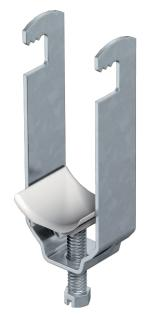
Passend zu Flach-, Winkel- und U-Eisen von 4 - 12 mm Materialstärke. Schelle und Schraube aus tauchfeuerverzinktem Stahl.  $\label{eq:continuous} {\it Druckwanne\ aus\ Polypropylen,\ halogenfrei,\ Farbe\ Lichtgrau\ RAL\ 7035.}$
