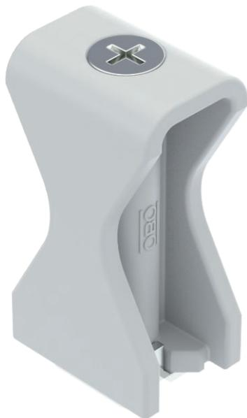
Schwere Ausführung, auch passend zu Schienen mit 16 ÷ 17 mm Schlitzweite; Schellenkörper Polyamid, lichtgrau RAL 7035; Metallteile Stahl, galvanisch verzinkt.
