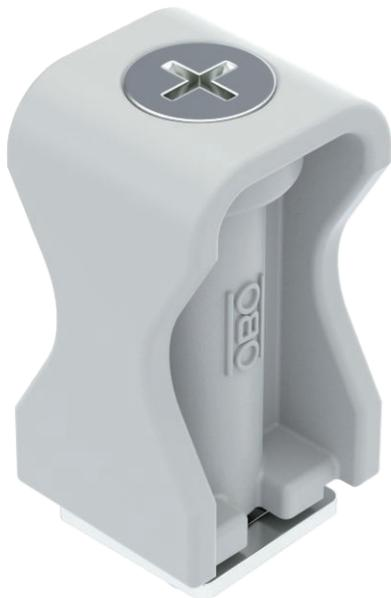
Schwere Ausführung, auch passend zu Schienen mit 16 ÷ 17 mm Schlitzweite; Schellenkörper Polyamid, lichtgrau RAL 7035; Metallteile Stahl, galvanisch verzinkt.
