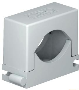
Universalschelle für Einzelbefestigung von Kabeln, Leitungen und Rohren, alle Größen sind beliebig untereinander anreihbar, mit Klebefuß, Langloch und zum Aufschrauben auf Gewinde M6. Zum Kleben der Polyamid-Schellen auf Mauerwerk und Beton Impu-Fix-Stegleitungs-Schnellkleber Typ 509 verwenden.
