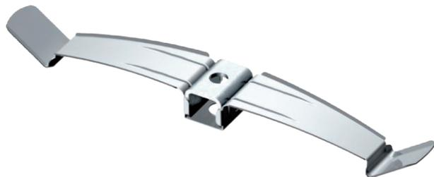
Die Kabelklammer aus Metall ist halogen- und brandlastfrei und bietet auch im Brandfall hohe mechanische Standfestigkeit. Die Kabelklammer ist als kabelspezifische Variante für den elektrischen Funktionserhalt gem. DIN 4102 Teil 12 zugelassen. Das Distanzstück 2033 D 15 x 3 G (separat zu bestellen) vergrößert bei Kabelklammern die Klemmhöhe von 10 auf 13 mm. Die Kabelklammer eignet sich zur brandsicheren Montage oberhalb abgehängter Brandschutzdecken nach DIN 4102.
